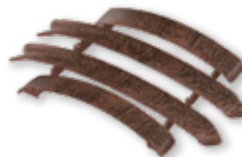
**Наличники из вспененного пластика** предназначены для декоративного оформления оконных и дверных проемов, порталов и рамок. Выполнены из качественного вспененного ПВХ-компанда в виде профилей прямой формы со скругленными углами. Наличники не гигроскопичны, не чувствительны к перепадам температур и могут быть установлены в помещениях с влажным режимом эксплуатации.
